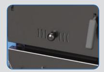
Einstellbare Lüftungsöffnung an der Ladetür dient zur "Trocknung" des Verbrennungsraumes und vermindert damit die Ansammlung von Teer und anderen Belägen an den Wänden.
